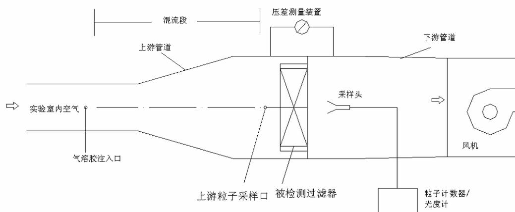
图 1 扫描检漏法检测示意图
